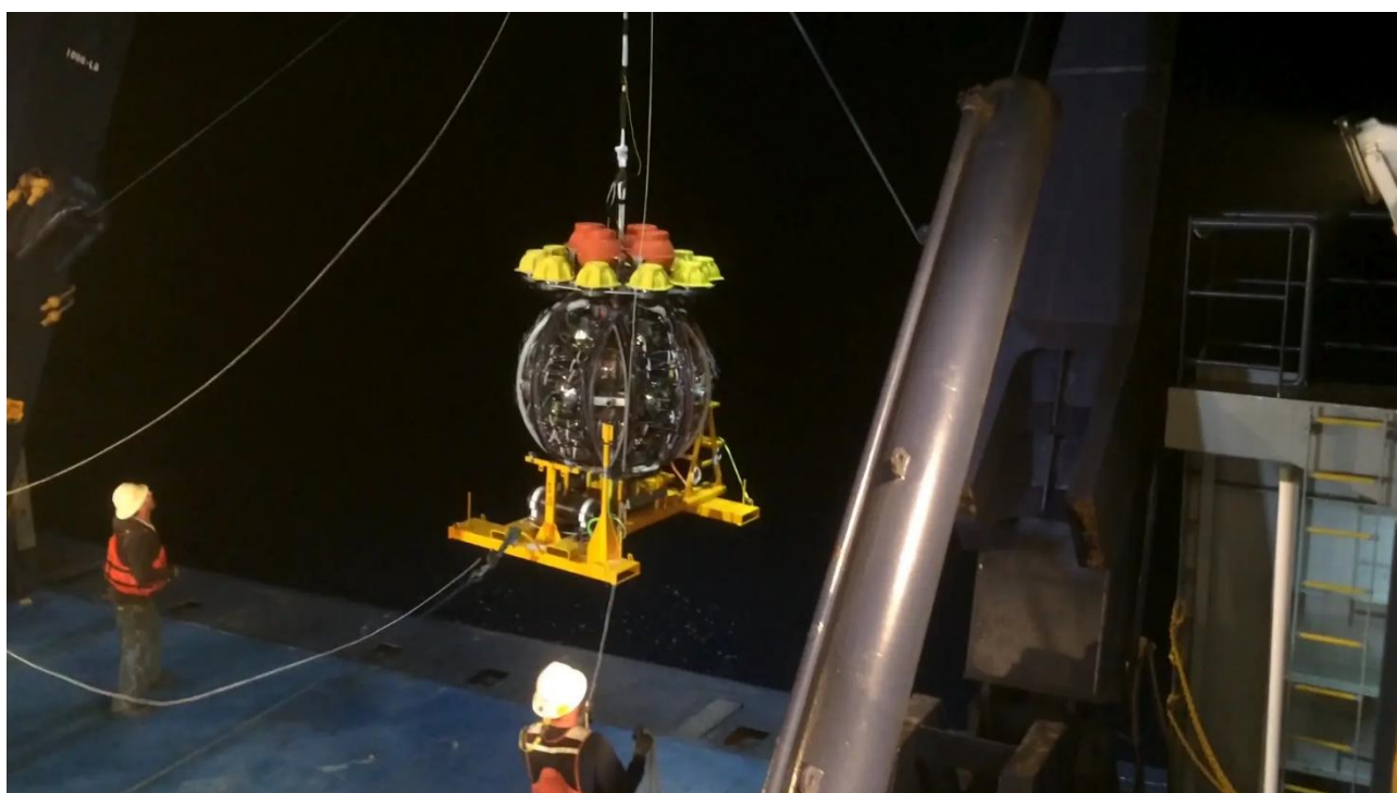
Moduli ottici dotati di microfoni per il monitoraggio delle onde acustiche sottomarine
